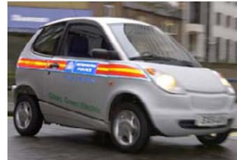
En 2002, la police métropolitaine de Londres a utilisé deux voitures électriques avec une distance maximale de 85 kilomètres (53 miles) et une vitesse maximale de 90 km/h (56 mi/h).
