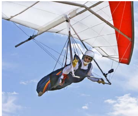
Le harnais du deltaplane aide à garder son corps droit de façon à minimiser la résistance du vent.
