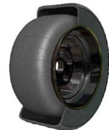
Vue d'une coupe transversale d'un pneu de course révélant l'intérieur
